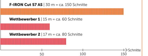
\* in 2 mm Stahl (Vierkantrohr 50 x 50 x 2 mm)
